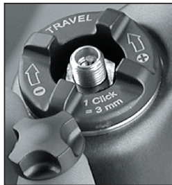
Fig. 2: Mando del tapón superior de aire y válvula Schrader de TALAS
